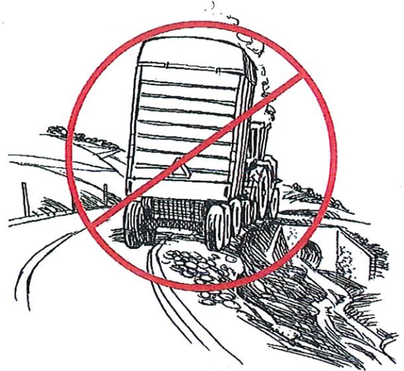
Evite los bordes de caminos arenosos y orillas angostas.
